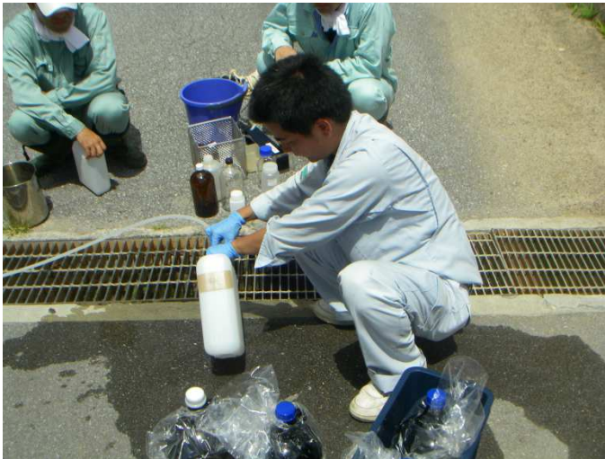
St. ②でのポンプによる直接採水
