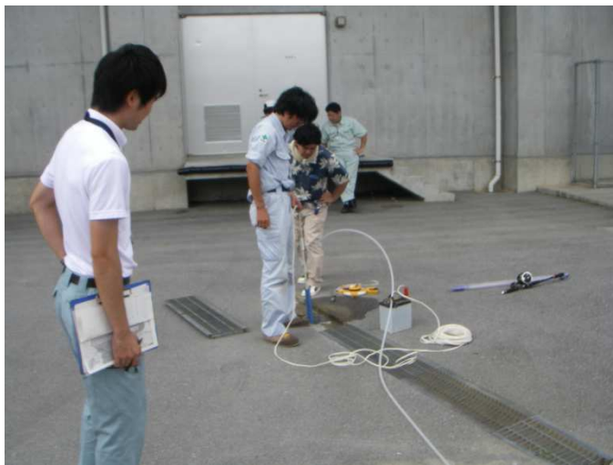
St. ② 揚水ポンプによる試料採取
