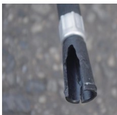
× ノズルの破損
