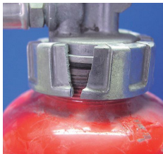
× キャップの破損
